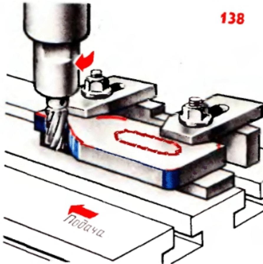
Фрезерование фасонной поверхности
