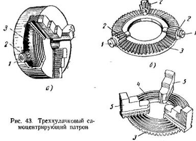
Рис. 43 Трехлопастный самоцентрирующий патрон
