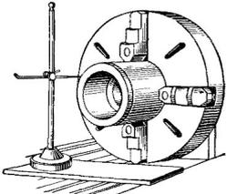
Рис. 42 Проверка установки детали при помощи рейсмуса
