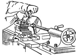
Рис. 44 Установка и закрепление детали в патроне
